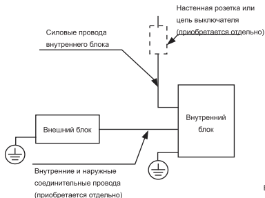
Подача питания в моделях со стороны внутреннего блока
